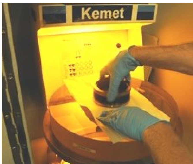
Obr. 8 – Čištění součásti před měřením. [18]
