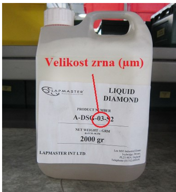
Obr. 7.3 – Směs oleje a diamantového prášku 3 \mu\text{m} .
