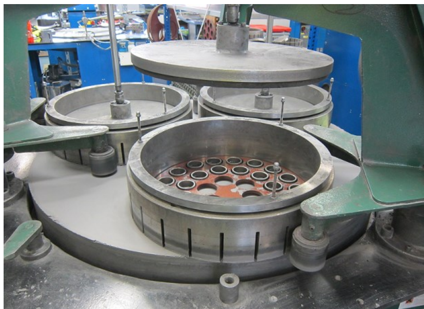
Obr. 10 - Lapování kalených kroužků „HCC“.
