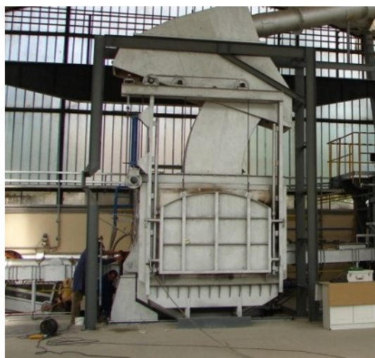
Obr. 1.6 Tavicí pec výrobce Stinchcombe Furnaces Group, s lanovým převodem [1]
