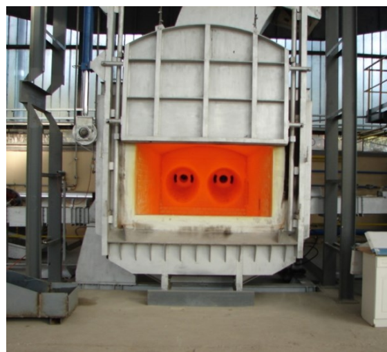
Obr. 1.7 Tavicí pec výrobce Stinchcombe Furnaces Group, s lanovým převodem [1]
