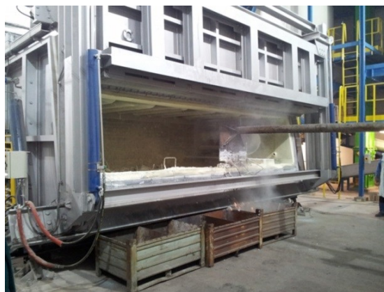
Obr. 1.10 Tavicí pec výrobce Stinchcombe Furnaces Group, typu Side Well na tavení hliníku [1]
