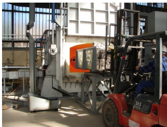
Obr. 1.2 Vsazení šrotu do otevřené pece ve formě balíků [1]
