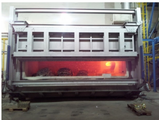
Obr. 1.9 Tavicí pec výrobce Stinchcombe Furnaces Group, typu Side Well na tavení hliníku [1]
