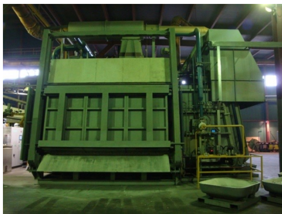
Obr. 1.3 Plynová vícekomorová tavicí pec výrobce Stinchcombe, hlavní komora, pohon dvěma hydromotory [1]
