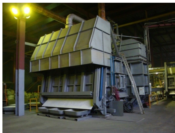
Obr. 1.4 Plynová vícekomorová tavicí pec výrobce Stinchcombe, boční komora, ovládání dvěma hydromotory [1]
