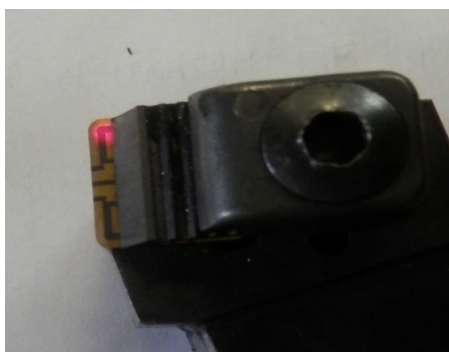
Obr. 6.1 Ukázka použití laseru infrapyrometru MAURER - KTR 1085-1
