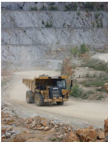
Obr. č. 2 – Etážový způsob těžby a doprava vápence na dampru [13]
