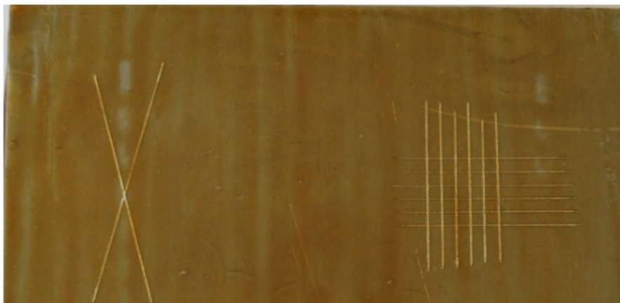
Obr. 17 – Vyhodnocení stupně poškození u nátěru „VCI“
