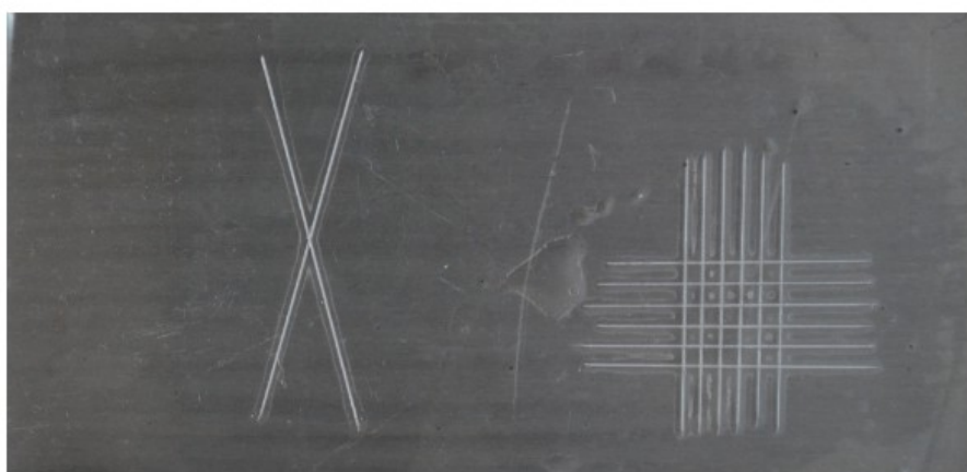
Obr. 18 – Vyhodnocení stupně poškození nátěru „IPPT“
