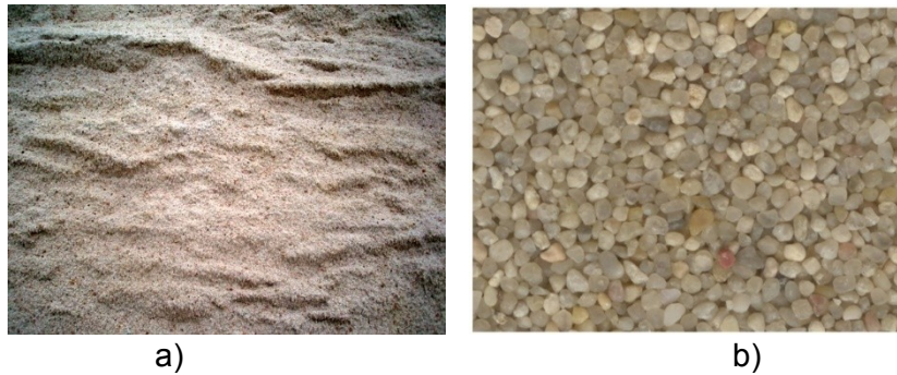
Obr. 3 – Tryskací materiál: a) sklářský písek [10]; b) křemičitý písek [11]
