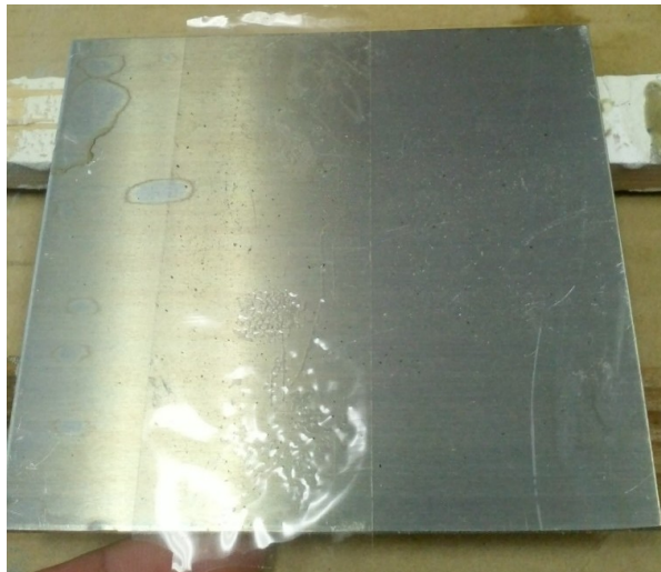
Obr. 10 – Nalepení samolepící pásky na podkladový materiál
