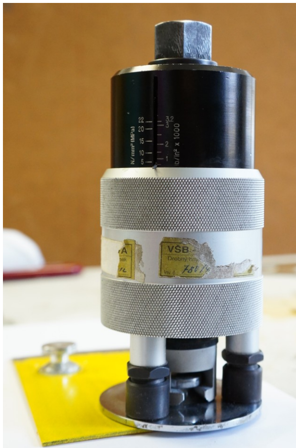
Obrázek 8 - Odtrhoměr Elkometer nasazený na panenku
