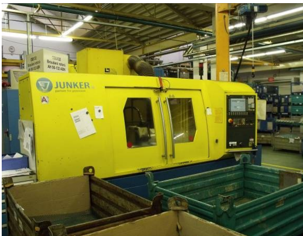
Obr. č. 7. Broušení hřídelí strojem Junker EJ 30 ve firmě SIEMENS s.r.o.
