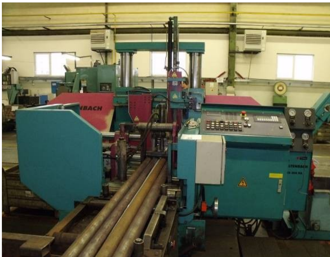
Obr. č. 4. Automatizovaná pásová pila Kaltenbach KB 305NA ve firmě SIEMENS s.r.o.
