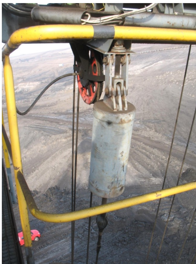
Obr č. 5 Umístění pružinového tlumiče na zdvihadle (foto autor)
