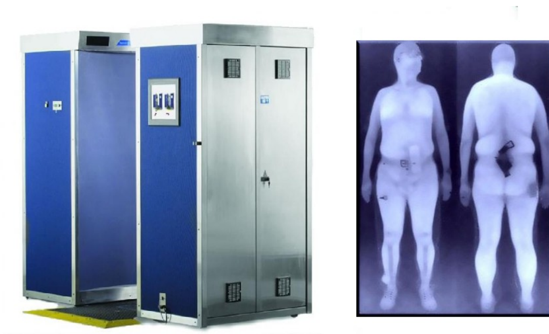
Obr. č. 4.2 Detektor na bázi rozptylu a z něj pořízený snímek
