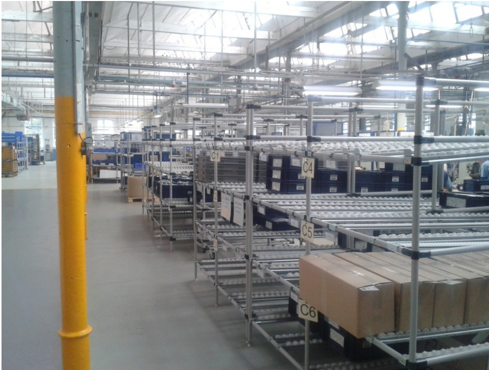
Obr. č. 27 Umístění skluzových regálů na hale
