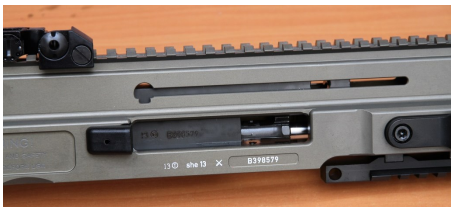
Obr. 5.8 Kontrola uzamykacího rozměru pomocí měrek [7]
