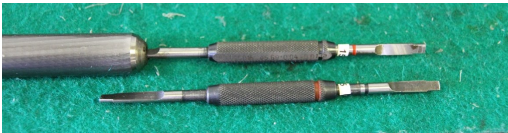
Obr. 5.4 Kalibry pro měření průměru vývrtnu v drážkách a šířku drážek v hlavni [7]
