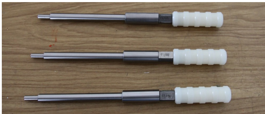
Obr. 5.2 Sada kalibrů pro měření sousosti sestavy hlavně [7]
