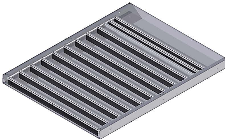
Obr. 7.5: Sestava příčného dopravníku [17]
