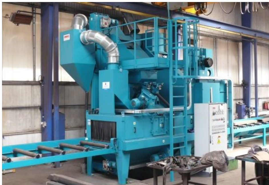
Obr. 2.4: Tryskací zařízení s válečkovou tratí [2]
