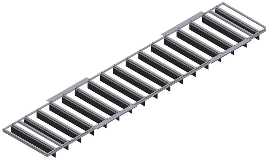
Obr. 7.3: Sestava podélného pohyblivého rámu [17]
