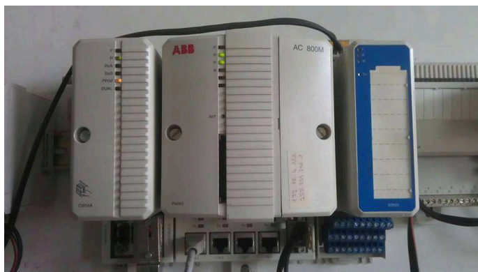
Obr. 4.2 Modulární PLC od firmy ABB
