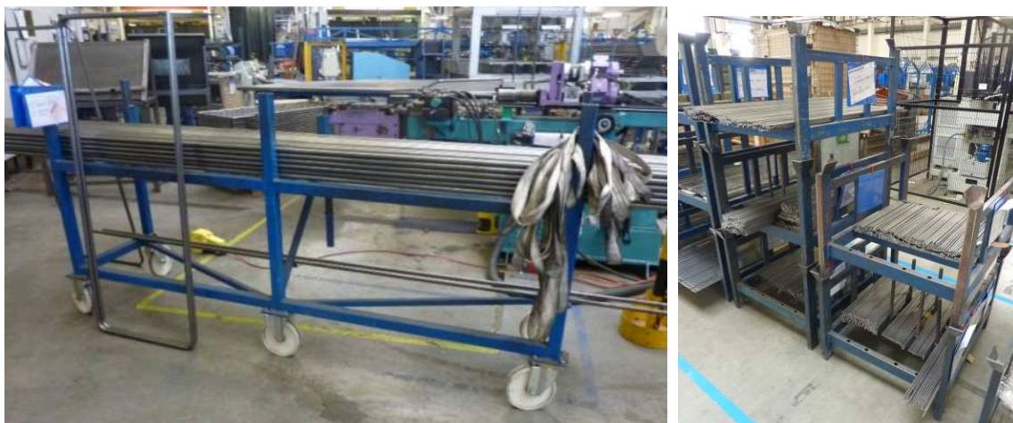
Obr. 6 Uložení nařezaných tyčí v pojízdném zásobníku a palety s drátem
