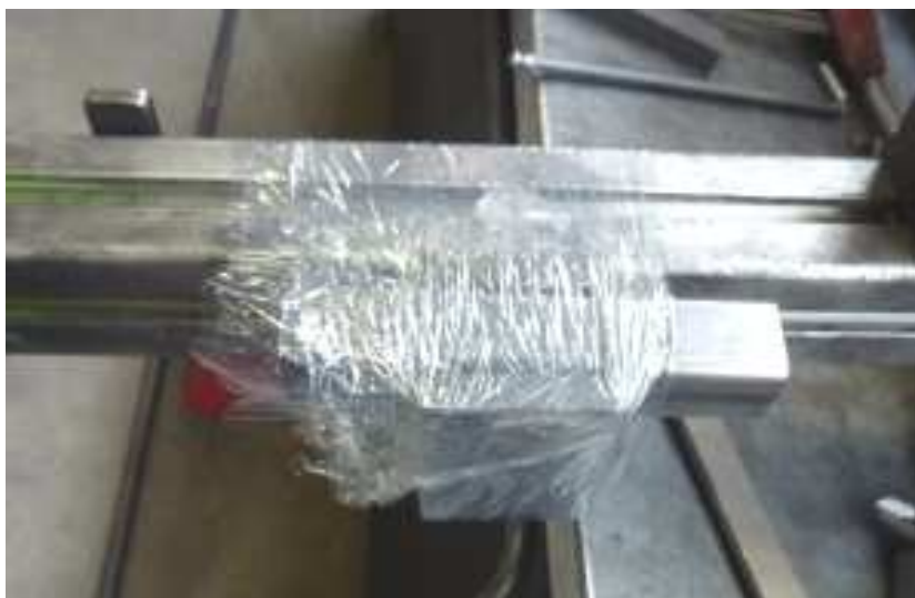
Obr. 20 Dosažení požadovaného nastavení přípravku pomocí pásky a krátkého jáklu
