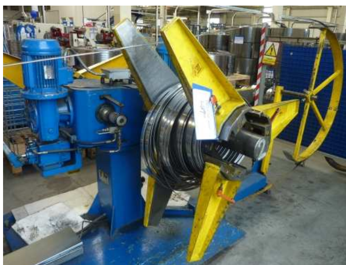
Obr. 17 Odvíječ cívky s pásovinou je oboustranný a otočný
