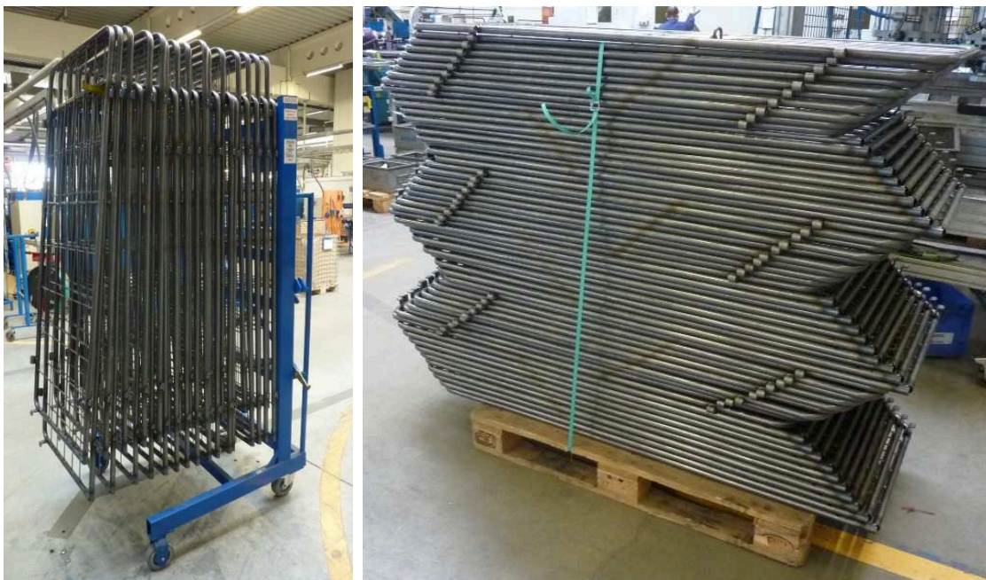
Obr. 7 Způsoby uložení bočnice kontejneru: UNI stojan a euro paleta
