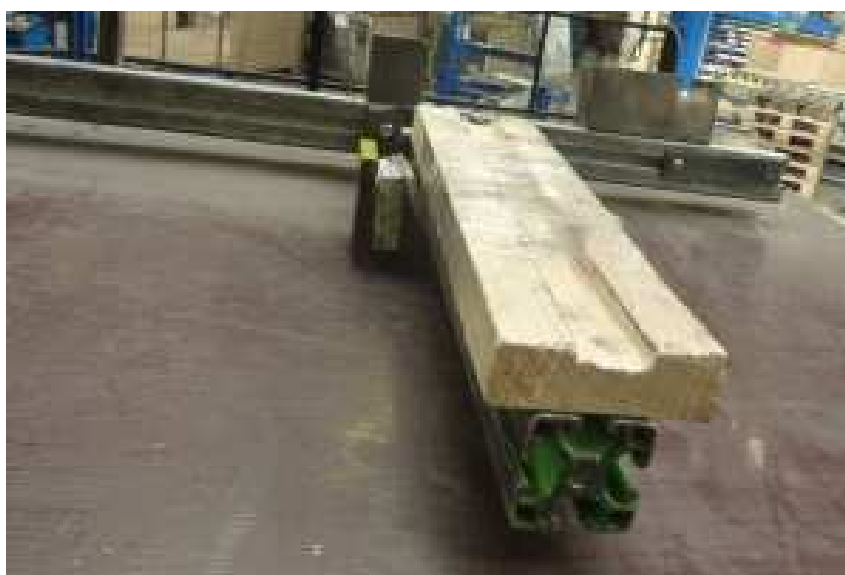
Obr. 21 Jiný způsob řešení pro nastavení polohy dílce v přípravku
