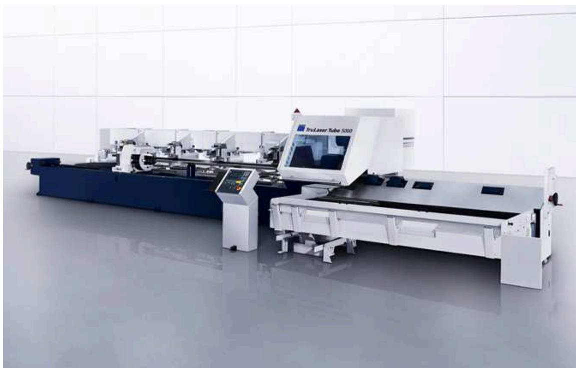
Obr. 33 Stroj TruLaser Tube 500 společnosti TRUMPF [17]
