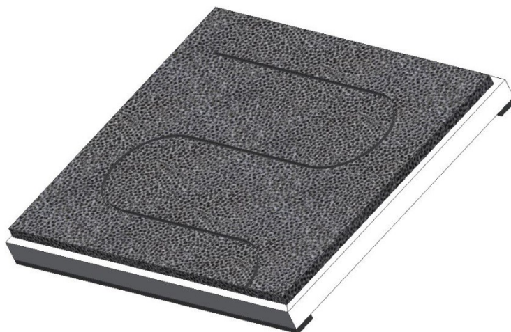
Obr 11.1 Sestava pěnokeramické vrstvy s drážkou, žáruvzdorné keramiky a podpěr
