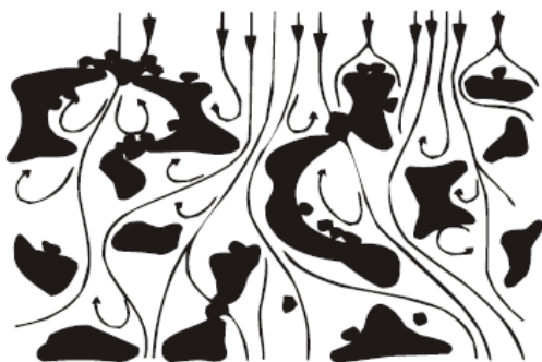
Obr. 8.3 Proudění v pěnovém filtru [25]
