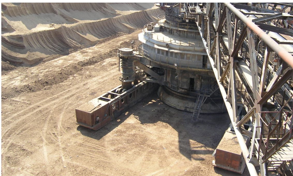
Obr. 36 – Detail podvozku rýpadla ERŠR 5000
