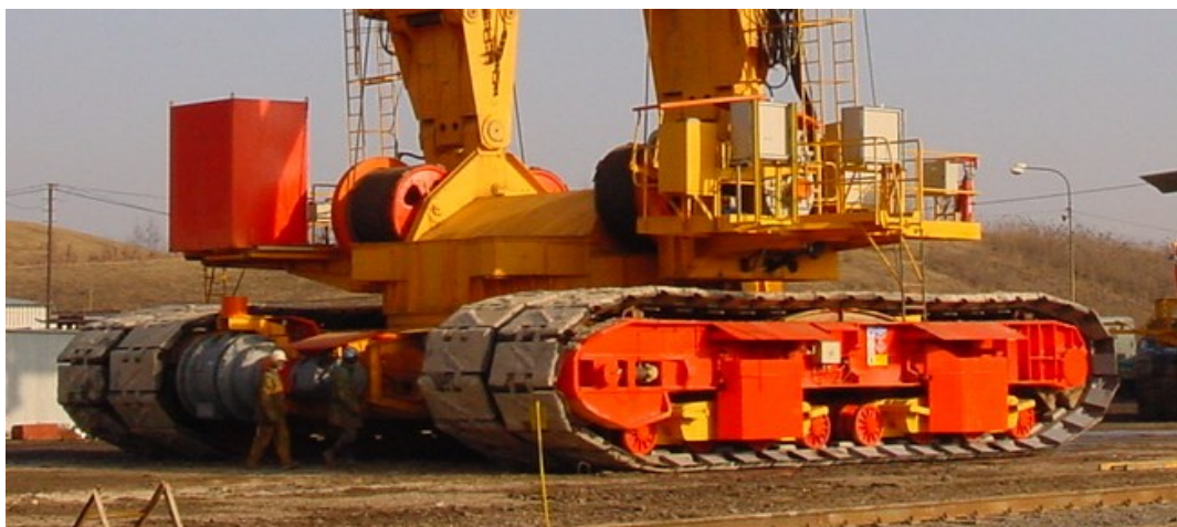
Obr. 17 – Podvozek podpěrného vozu nakládacího výložníku rýpadla KU 800
