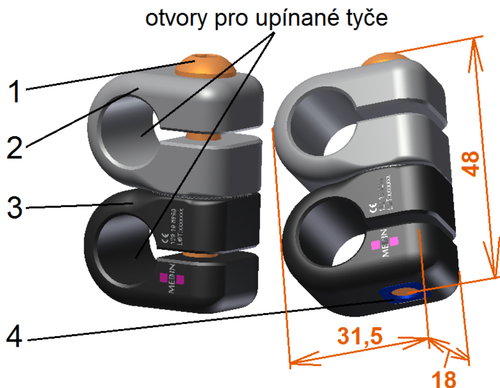
Obrázek 56 - upínka typu tyč-tyč; 1-šroub, 2-svorka 1, 3-svorka 2, 4-čtvercová matice
