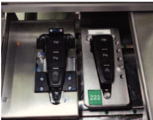
Obr. 8 Odkrytá základací pozice [8]
