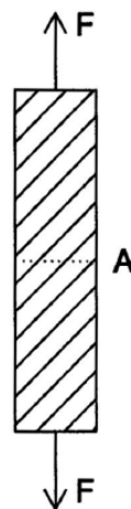
Obrázek 4 – Schéma zkoušky pro stanovení pevnosti horniny v jednoosém tahu F – maximální dosažená síla při porušení tělesa, A – počáteční průřezová plocha vzorku
