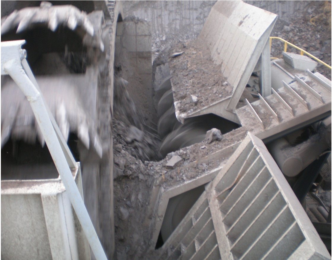
Obrázek 18 – Těžený materiál vypadává z korečků přímo pod hroty kruhadla
