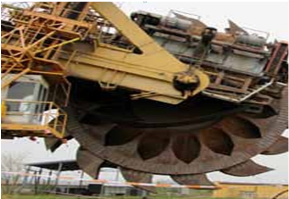
Obrázek 20 - Boční pohled na umístění kruhadla v násypce kolesového výložníku na KU800/8
