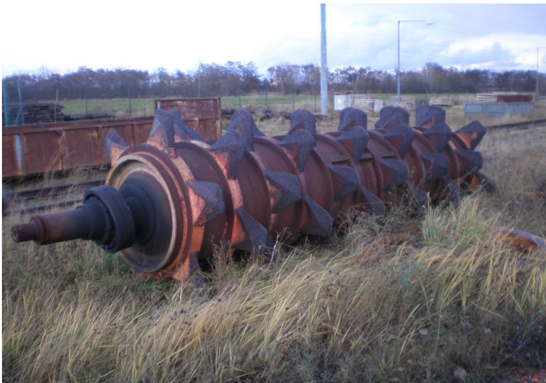
Obrázek 21 – Rotor kruhadla s lichoběžníkovými zuby
