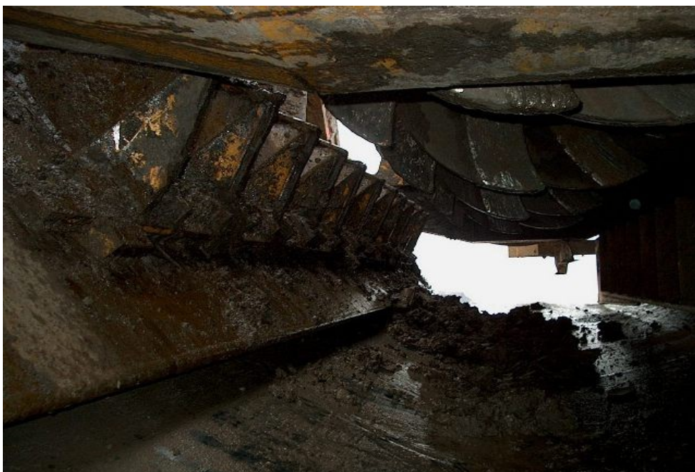
Obrázek 23 - Pohled na zuby rotoru a protistěny se spodu z dopravního pásma kolesového výložníku
