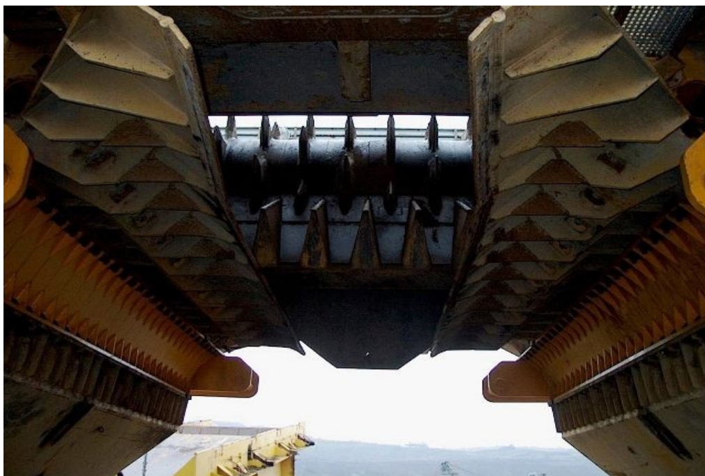
Obrázek 15 – Pohled od spodu na příčně uložené rotory Tangenciálního drtiče skrývky
