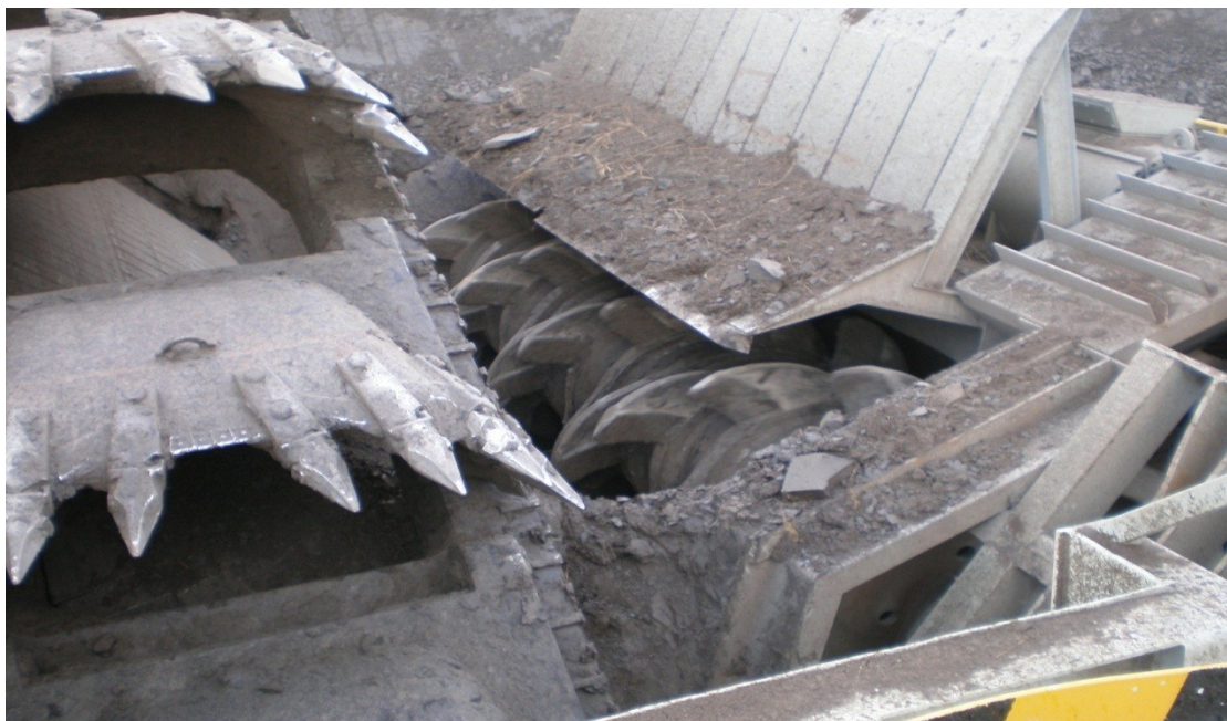
Obrázek 25 – Kruhadlo na SchRs1320 s rotorem osazeným prstenci s hroty profilu “žraločích ploutví”
