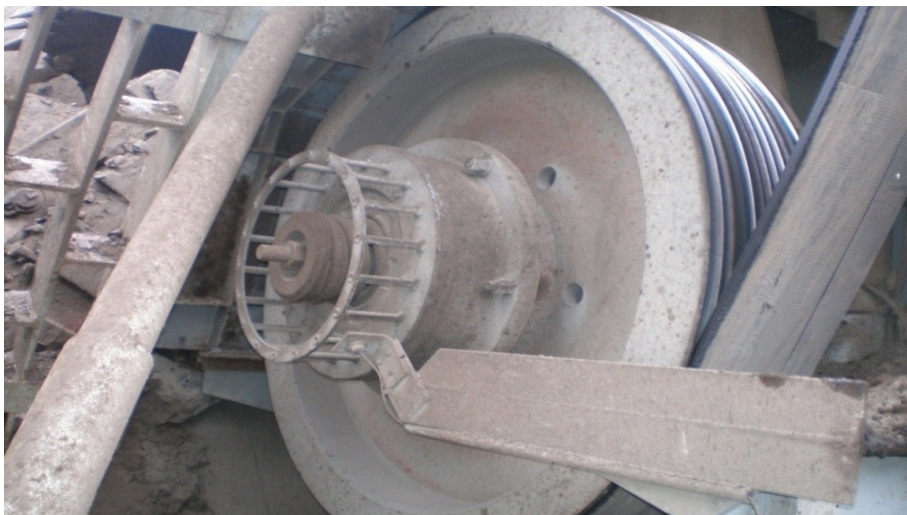
Obrázek 24 – Setrvačník kruhadla s drážkami a násobné klínové řemeny
