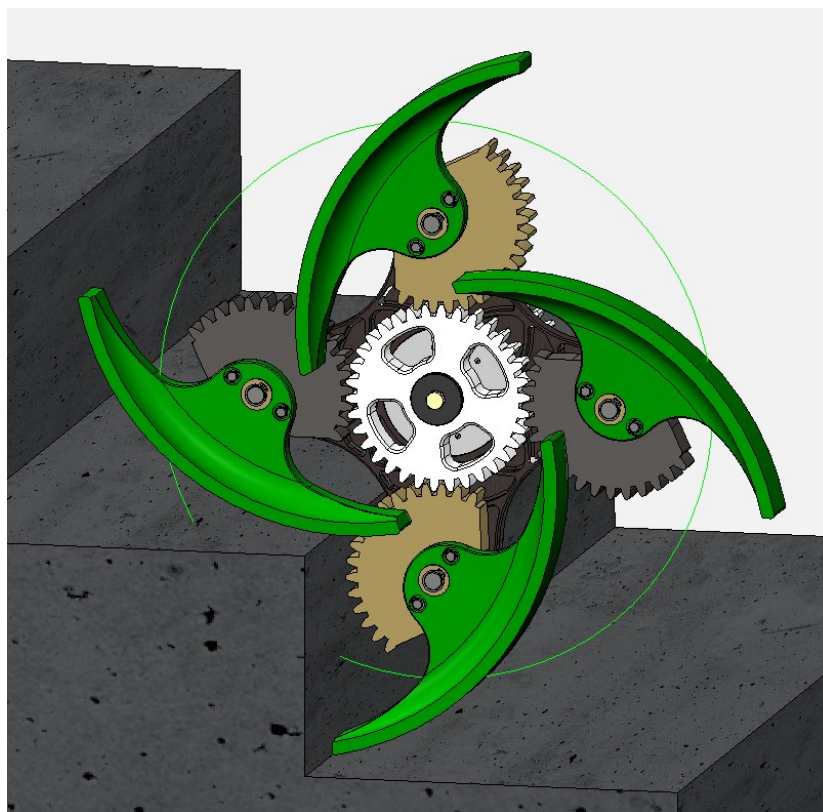
Obr. 5.2 – Sestava kola s ozubeným převodem při poloze na schodech
