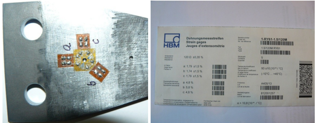
Obrázek 29 Detail použitých růžic, nalevo Vishay, napravo HBM
