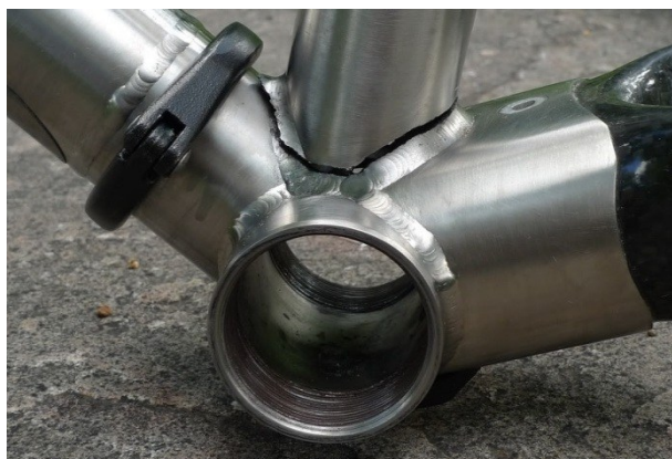
Obrázek 1 Lom vlivem residuálního napětí
