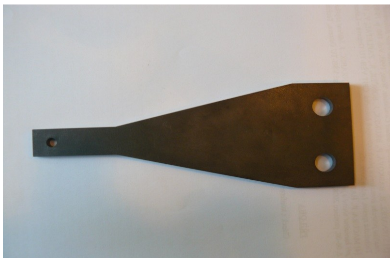
Obrázek 24 Zkoušený nosník stejné pevnosti
