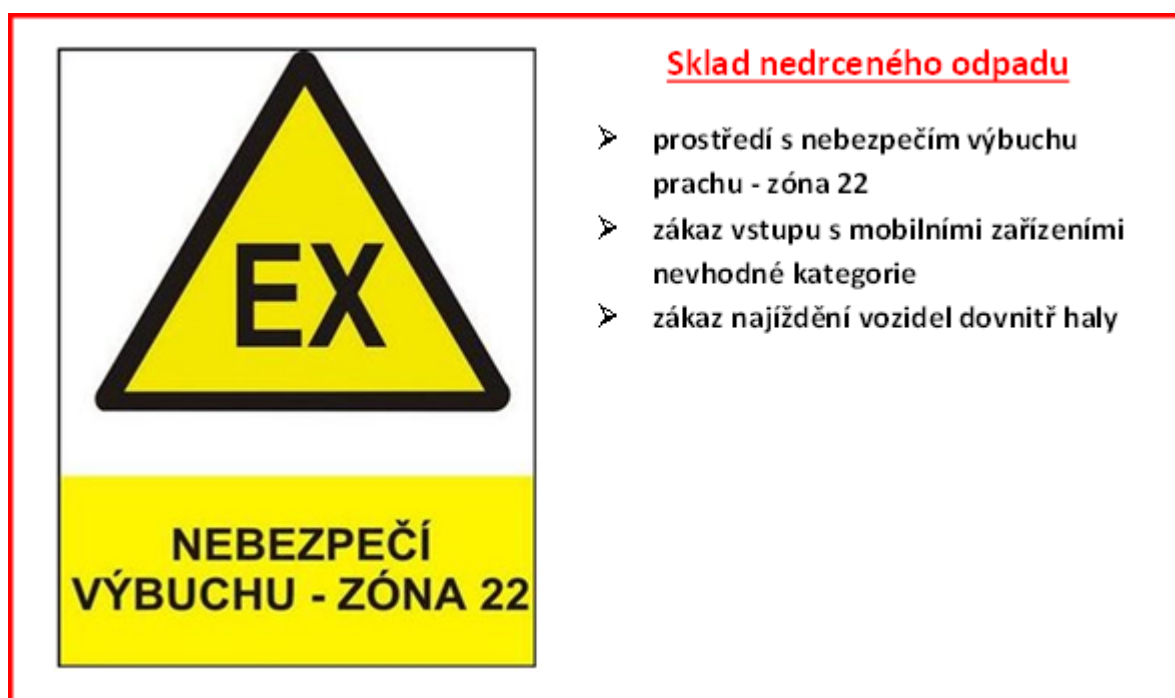
obr. 5.3 – návrh bezpečnostní tabulky pro umístění na vstupy do haly nedrceného odpadu
