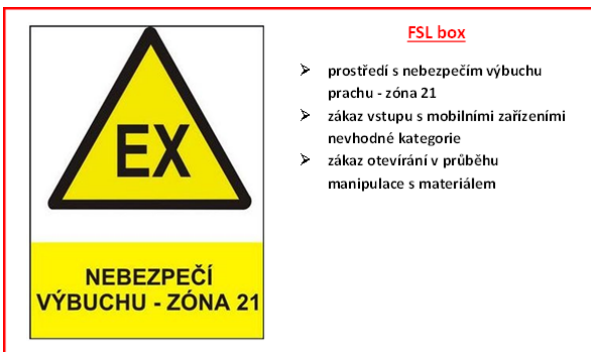
obr. 5.4 – návrh bezpečnostní tabulky pro umístění na vstupy do FSL boxů
