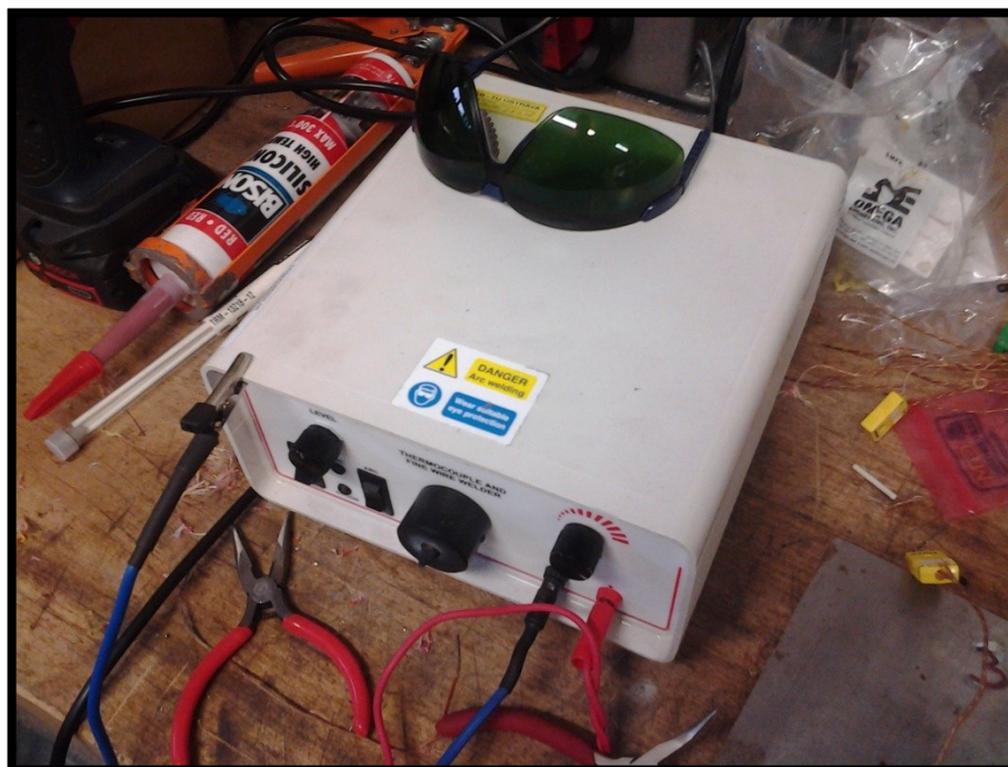
Obr.10 Kondenzátorová odporová svářečka
