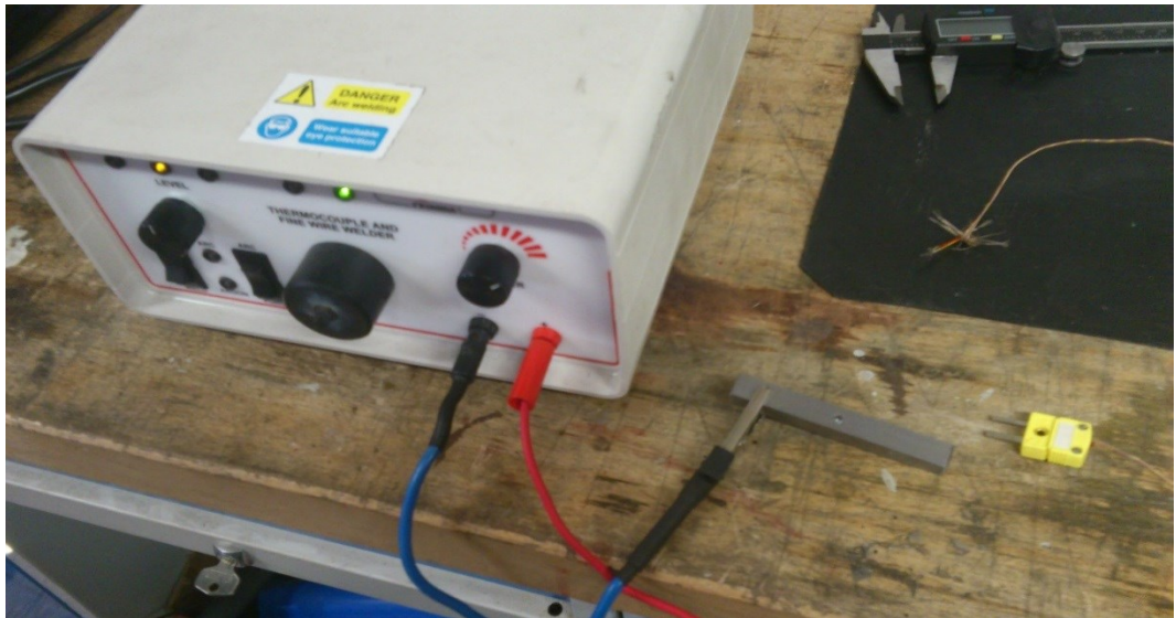
Obr. 9: Postup navaření termočlánku 1/2
