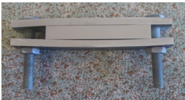
Obr. 32: Vyleštěný vzorek upnutý v kotvách
