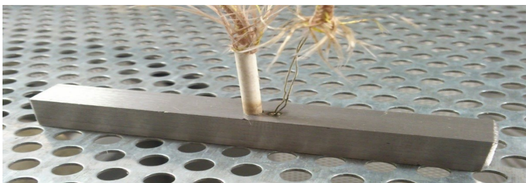
Obr. 30: Nový vzorek s navařeným termočlánkem uvnitř i na povrchu
