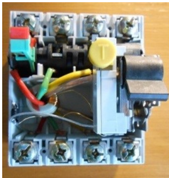
Obr. 6.1 Zde je zobrazený proudový chránič, ze kterého bude vymontován součtový transformátor.
