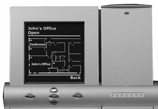
Obrázek 1.5: Grafická klávesnice bezpečnostního systému
