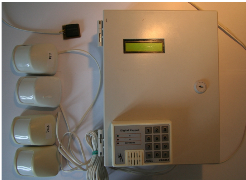
Obrázek 3.13: EZS umístěn v rozvaděčové skříni
