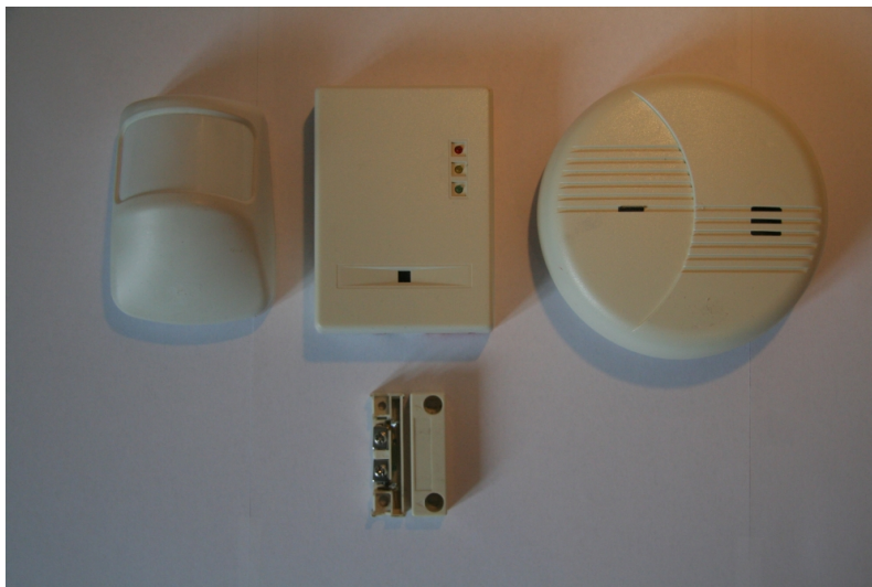
Obrázek 2.3: Ukázky senzorů. Zleva: Pohybový, zvukový a kouřový senzor. Dole je umístěn magentický.
