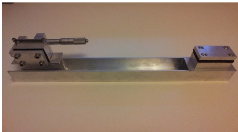
Obrázek 4.2: Přípravek pro uchycení optického vlákna pro měření síly v tahu [17]
