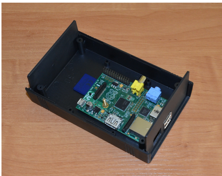
Obrázek B.5: Raspberry Pi upevněné v krabičce.
