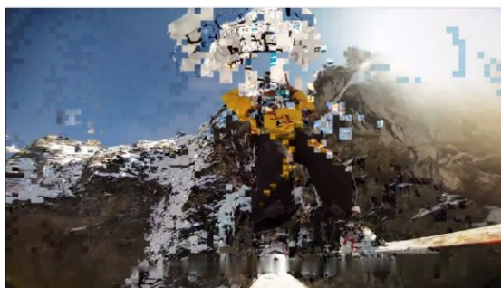
Obr. 6.52: Nastavený parameter - stratovosť paketov 2,5 %, u videa MPEG-2 HD.
