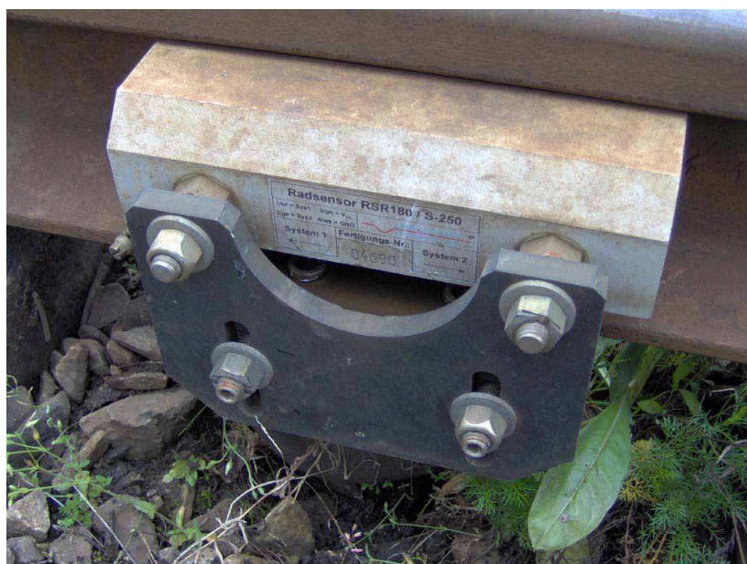
OBRÁZEK 15: ČIDLO POČÍTAČE NÁPRAV
