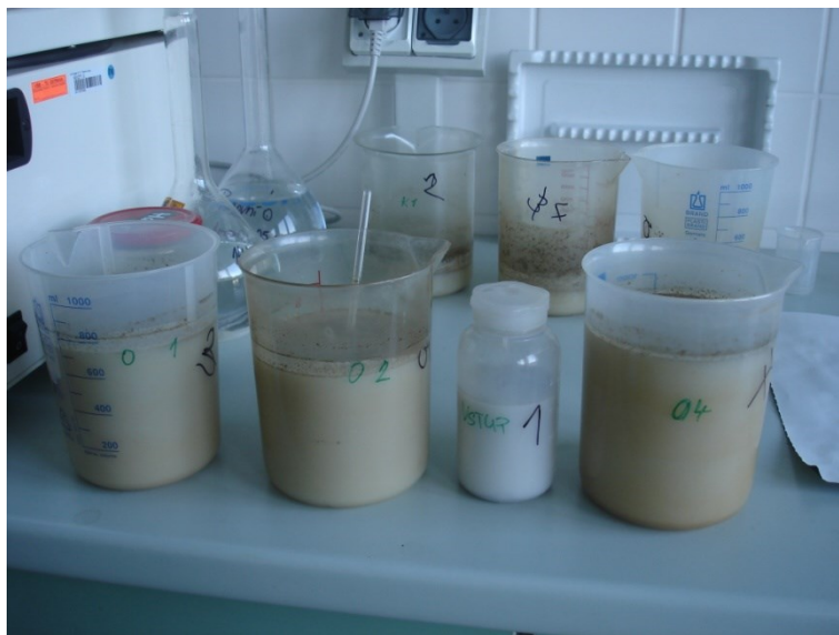
Obrázek 19: Odpady O1, O2 a O4 (po flotaci) před filtrací.
