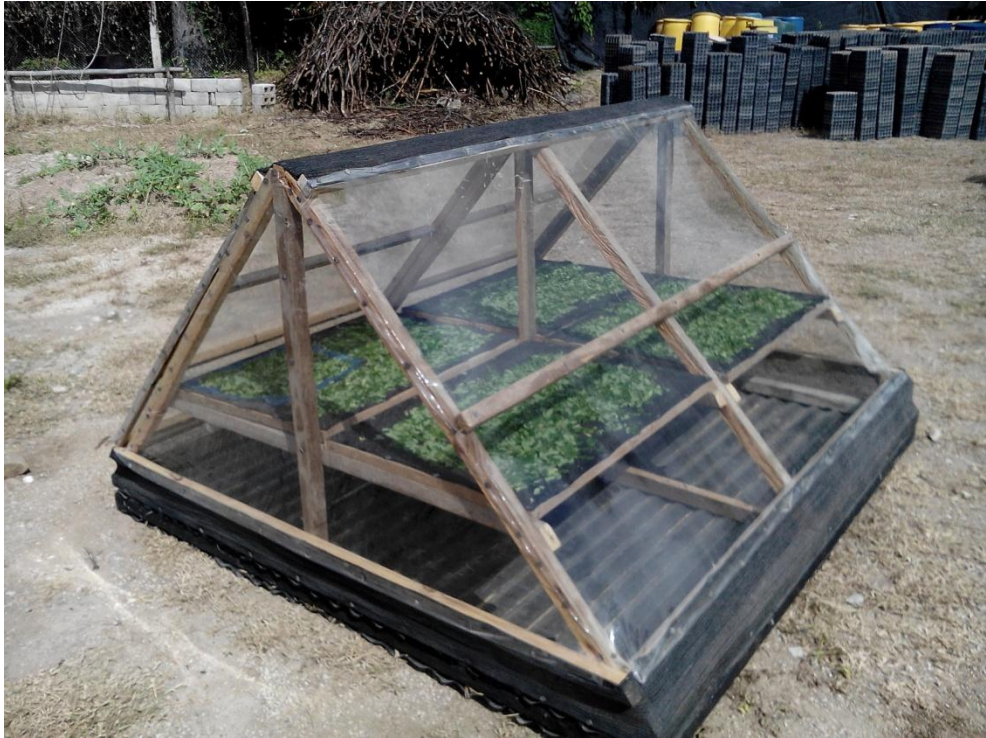
Figura 25. Deshidratador solar con muestras de Paraíso Blanco
