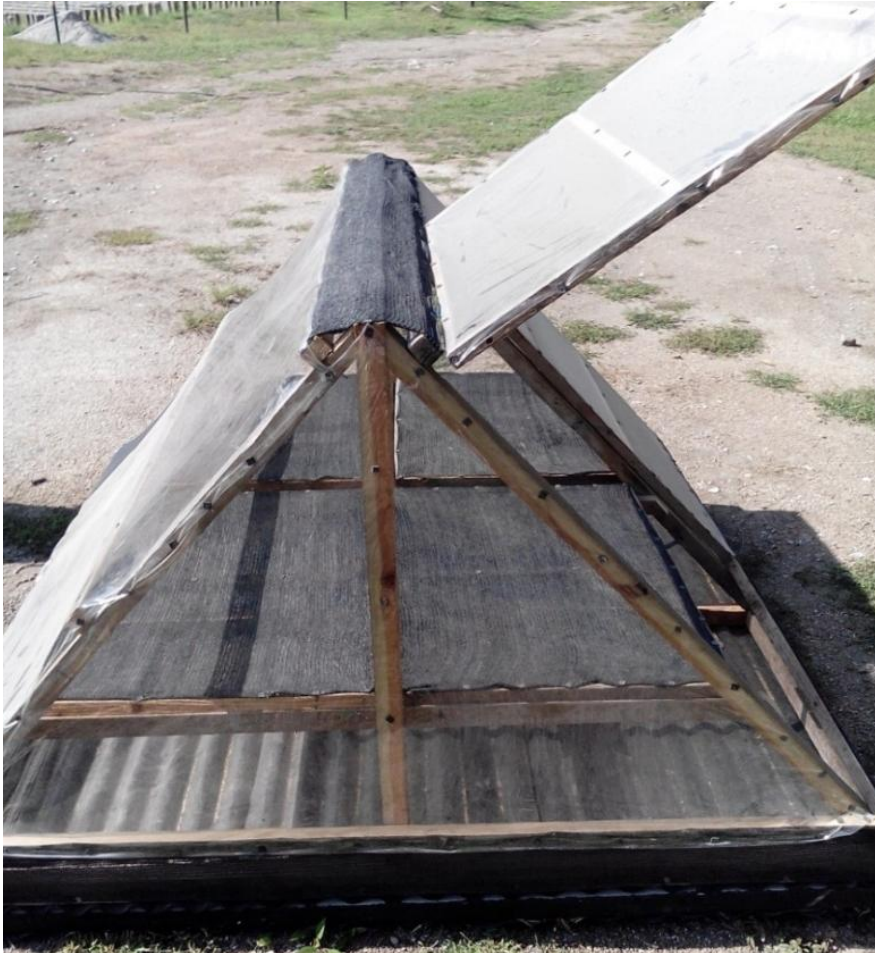
Figura 19. Deshidratador solar construido
