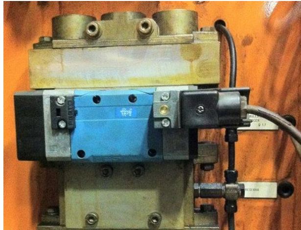
Figura 66: Eletroválvula responsável pelo movimento do tabuleiro
