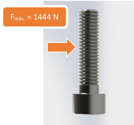
Figura 136: Esforço aplicado ao parafuso
