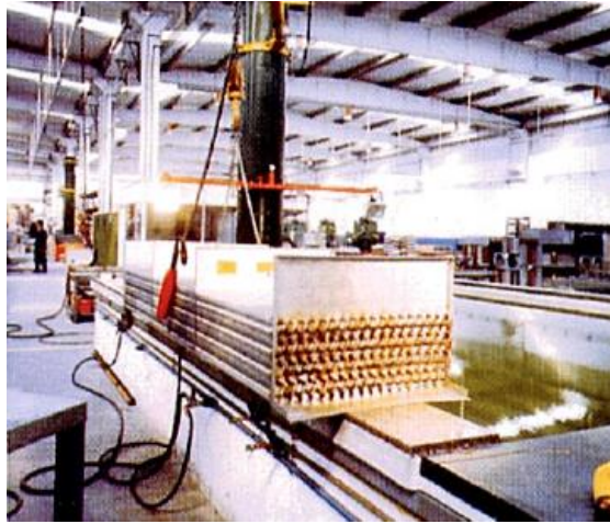
Figura 29 - Brasagem e soldadura de baterias
