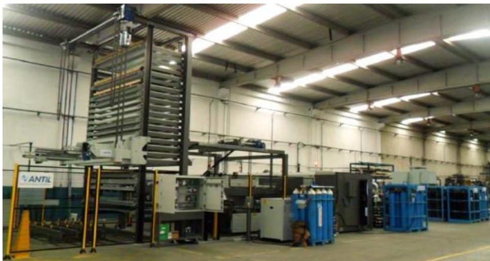
Figura 31 - Máquina de corte a laser para corte e furação de chapa e tubo
