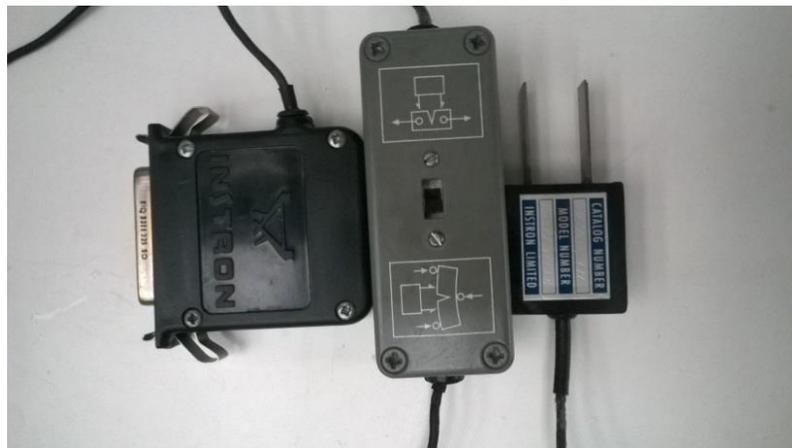
Figura 49 - Extensómetro de palhetas Instron 10/4
