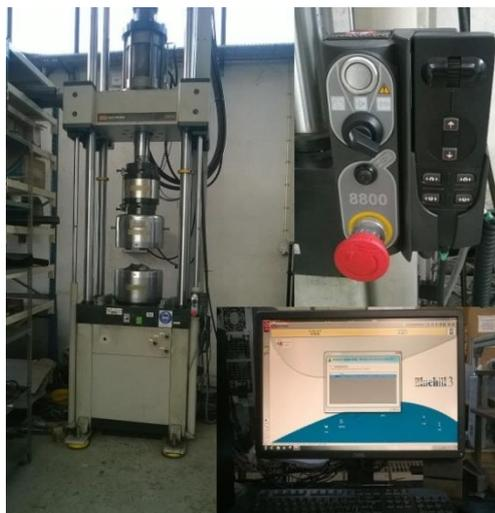
*Figura 47 - Instron 8204 com o comando e computador de controlo*
