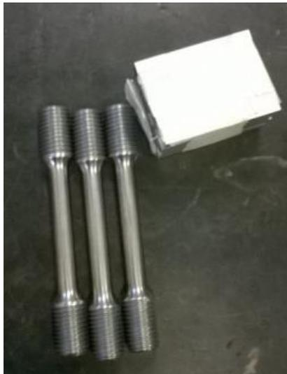
*Figura 39 - Provetes de tração e de Impacto de Charpy*
