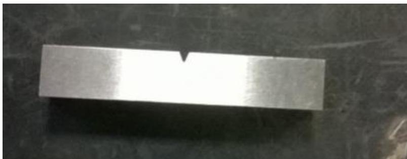
*Figura 40 - Provede de Impacto de Charpy Tipo A*
