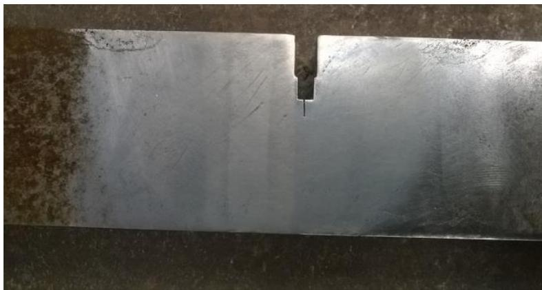
Figura 37- Provete proveniente de chapa soldada
