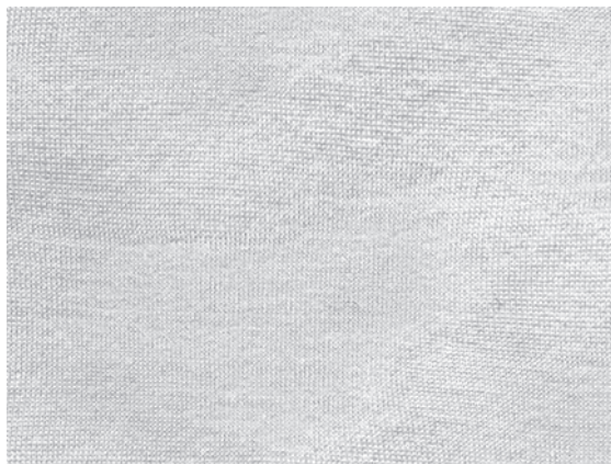
Slika 4: Vzorec bombažnega pletiva Spinit, izdelanega iz efektne preje, pri dvakratni povečavi
