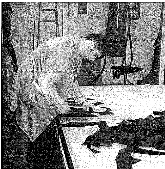
Slika 13: Delo odlagalca - pobiranje krojnih delov z delovne površine stroja za razrez usnja
