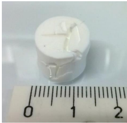
Slika 4-19: Vzorec semi- IPN po ekstrakciji PCL.
