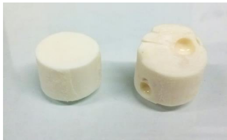
Slika 4-7: Primerjava reprezentativnega vzorca semi -IPN (s-SIN-3, levo) in vzorca z vidnimi mehurčki (s-SIN-2, desno).
