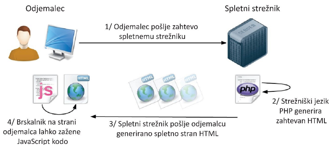
Slika 2.1: Princip delovanja tehnologije PHP [7].
