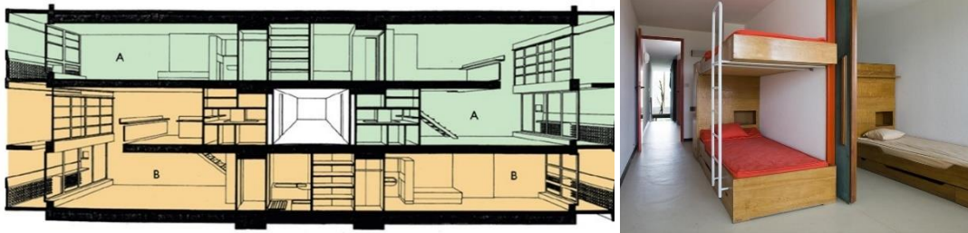
Figura 50 – Le Corbusier (1945-52) Unité d'habitation . Esquema com corte de edifício mostrando a configuração das células de habitação duplex e o corredor central.
