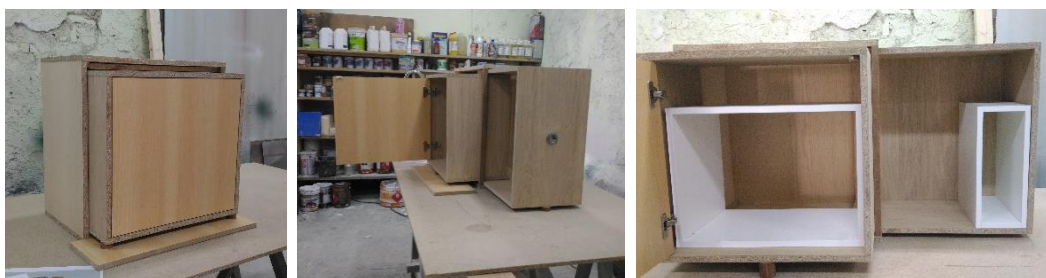
Figura 187 – Fotografias do segundo protótipo. Teste de solução de pés cilíndricos amovíveis e introdução de caixas organizadoras de espaço.
