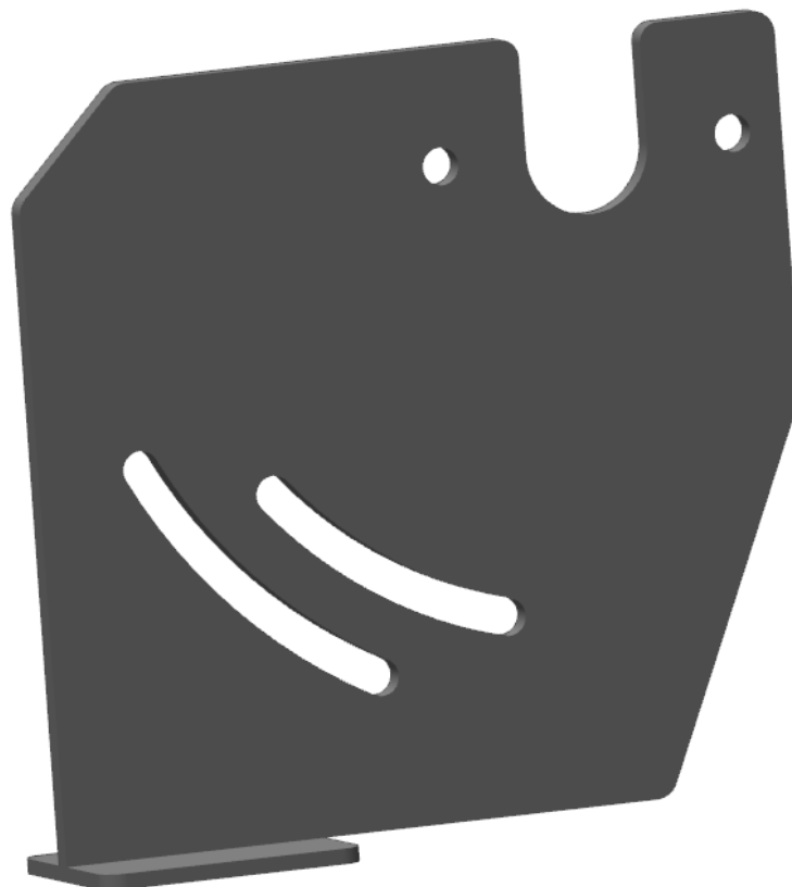
Kuva 6. Ensimmäinen 3D- luonnos kääntömekanismin kappaleesta
