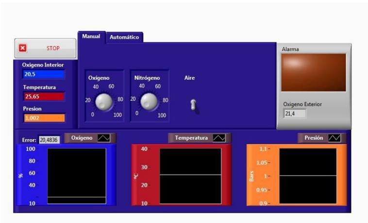
Figura 14. Pantalla principal del Software de la cámara de oxigenacon controlada
