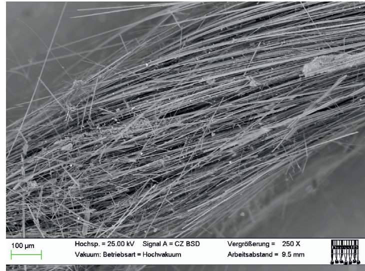
8 Faden aus Asbestfasern im Rasterelektronenmikroskop
