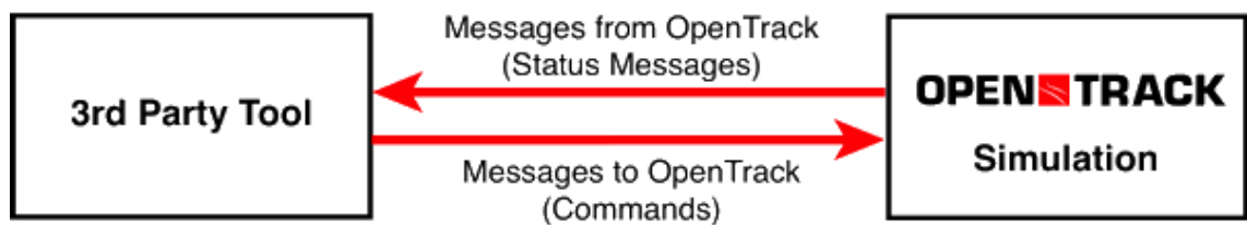
Kuva 11. OpenTrackin toiminta kolmannen osapuolen työkalun kanssa API-yhteyden välityksellä. (OpenTrack, 2017)
