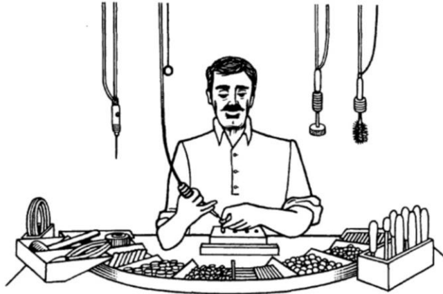
Ilustración 16. Disposición del material en dos arcos
