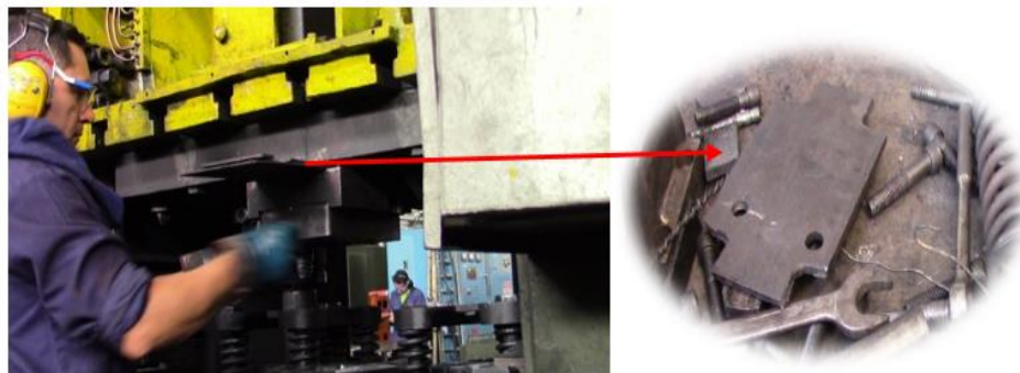
Ilustración 37. Montaje de platinas
