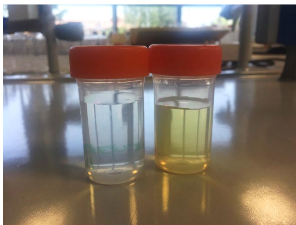
Figura 3. Diferencia en la coloración de las disoluciones de cenizas tras el procedimiento 1 (izquierda) y el procedimiento 2 (derecha).
