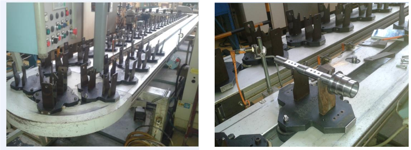
Fig.34 Transportador do carregamento automático GH.
