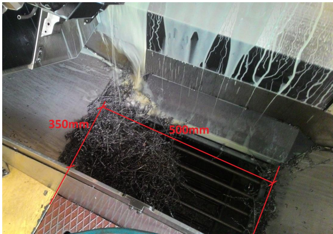
Fig.28 Caixa de despejo dos tornos
