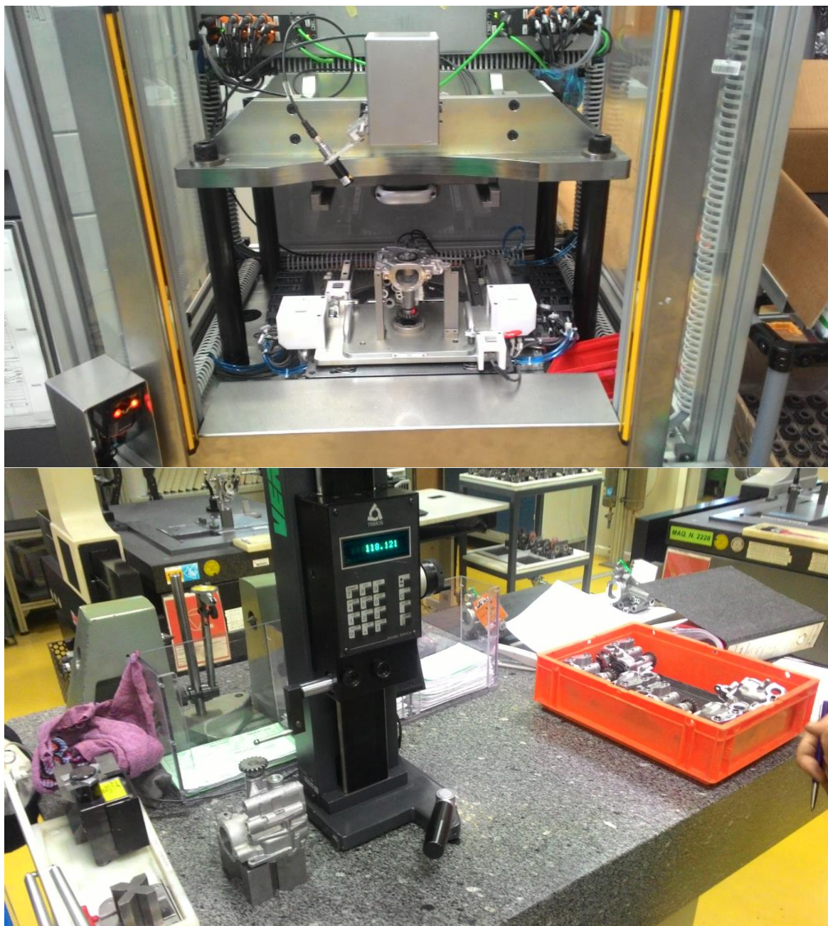
Fig.41 Medições no laboratório de metrologia AT3/4 após montagens efetuadas na linha
