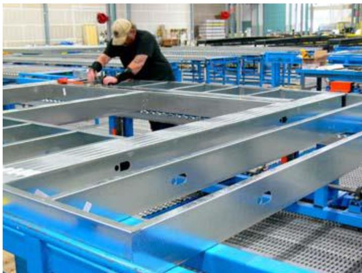
Figura 2.4 – Conceção de painéis em fábrica recorrendo ao Sistema Light Steel Framing (LSF) (Gaspar, 2013)
