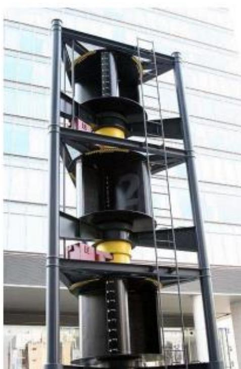
Figura 3.18 - Turbina eólica de eixo vertical do tipo Savonius (Maia, 2010).
