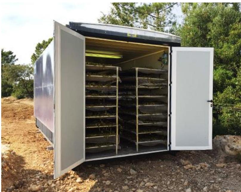
Figura 3.14 - Secador Solar Híbrido BLACK.BLOCK (BLACK.BLOCK, 2016).
