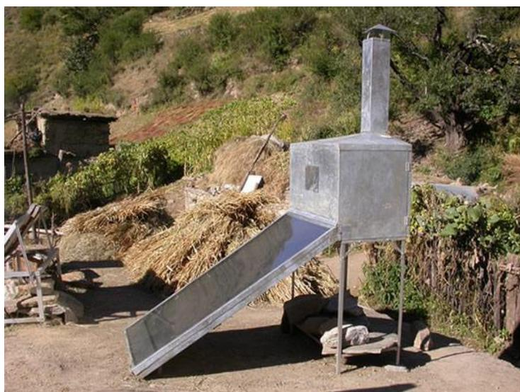
Figura 3.13 - Exemplo de um secador solar indireto (Solar Dryer, 2016).
