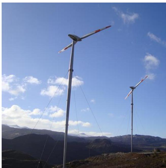
Figura 3.15 - Turbina eólica de eixo horizontal, com duas pás (Vergnet, 2010).
